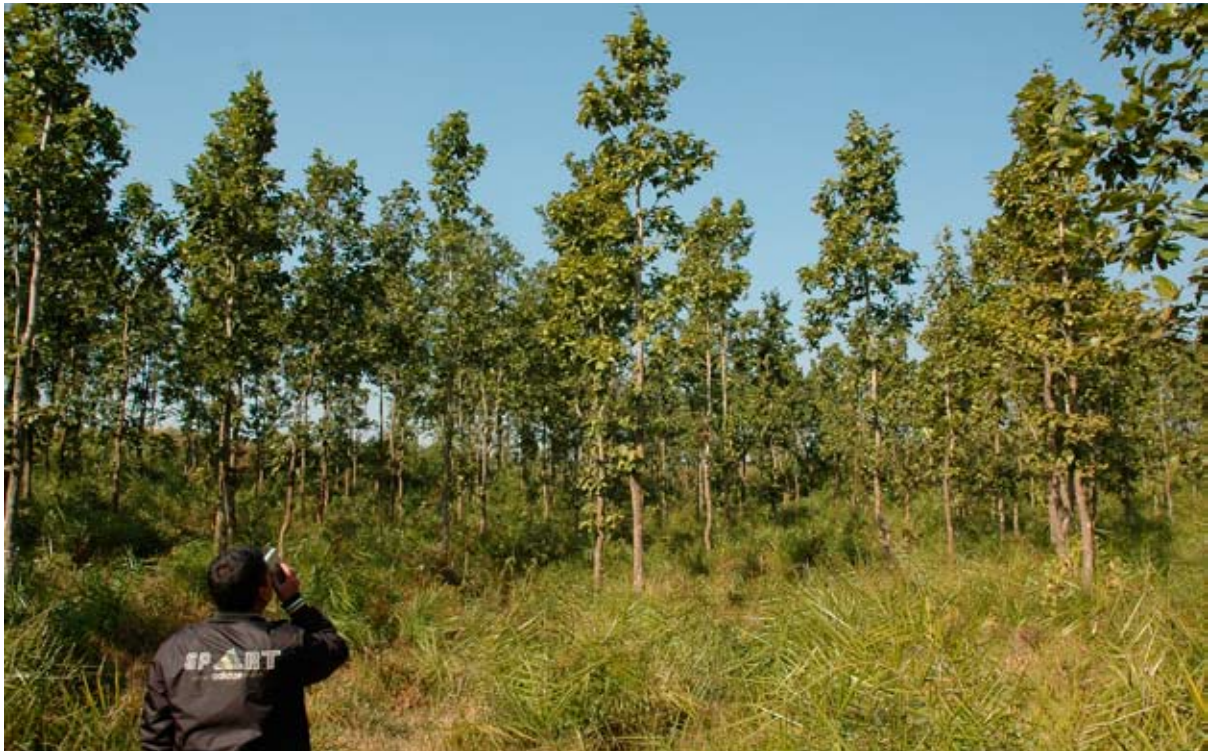
क्लिनोमीटरको सहायताले रुखको उचाई निकाल्न कोण नाप्दै।
